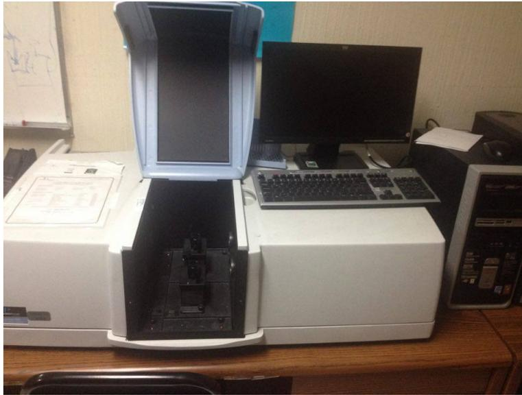
Figura 3.2: Espectrofotómetro UV/VIS
