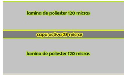
Figura 2.5: Esquema de la estructura de la PR EBT3 (Ashland INC.)
